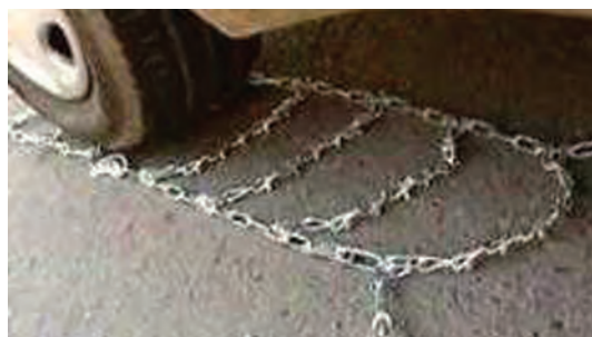
شکل ۱۳- بستن زنجیر چرخ
