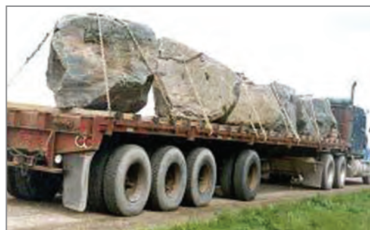
شکل ۱۶- نمونه‌ای از مهار صحیح سنگ‌ها
