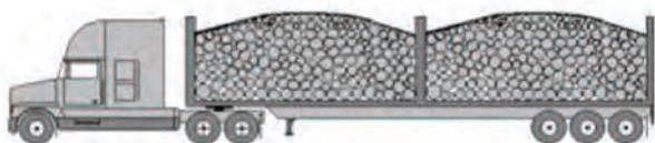
شکل ۴۷- نحوهٔ صحیح مهار عرضی چوب‌ها
