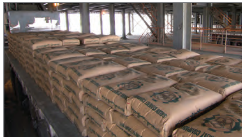
شکل ۱۲- نحوه چیدن کیسه‌ها روی یکدیگر
