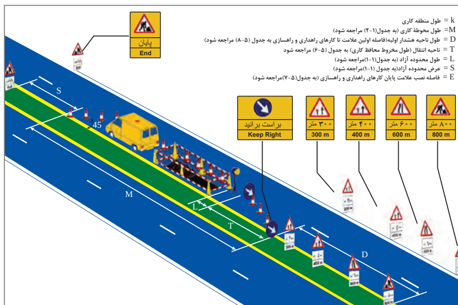
شکل ۲۵- طرح علائم گذاری در یک راه شریانی چهار خطه با جداکننده وسط که یک خط کناری آن بسته است.
