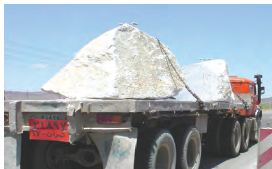
شکل ۱۷- نمونه‌ای از مهار نادرست سنگ‌ها
