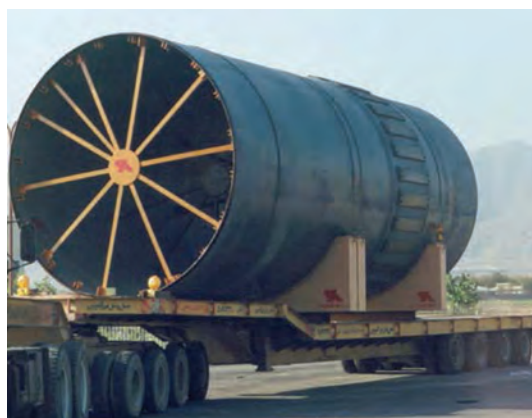
شکل ۵۸- روش مهار بار خاص توسط زین
