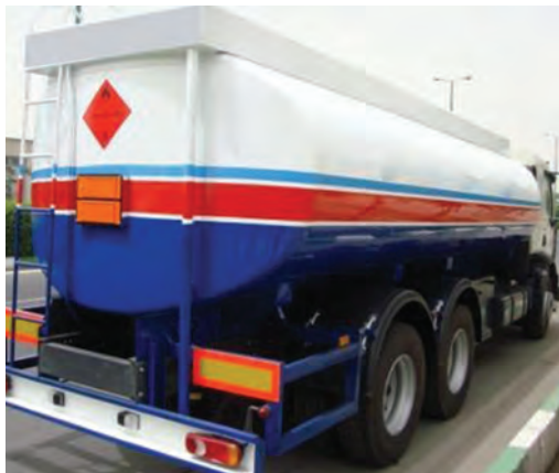
شکل ۳۳- علامت گذاری نشان دهنده گروه مواد خطرناک در پشت وسیله نقلیه
